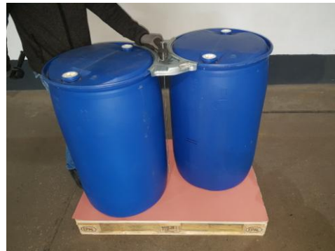
Antirutschmatte mit mindestens 0,6 Rh Reibbeiwert auf Palette auflegen und Fässer diagonal positionieren.
