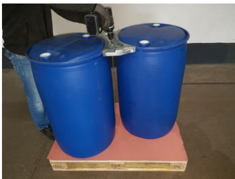
Schraube mit Akkuschauber in mittleren Palettenklotz einschrauben
