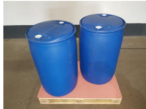
Antirutschmatte mit mindestens 0,6 Rh Reibbeiwert auf Palette auflegen und Fässer diagonal positionieren.
