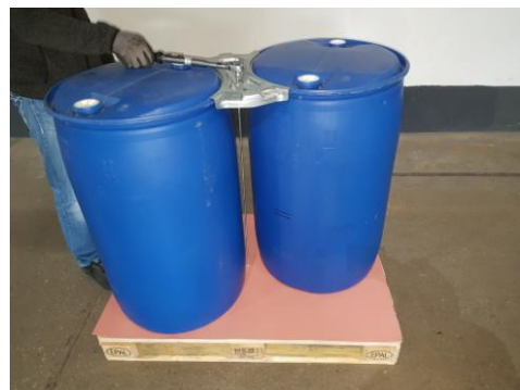
Schraube mit 35 Nm mittels Drehmomentschlüssel festziehen
